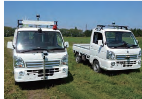
▲カメラ・LiDARによる自動運転
