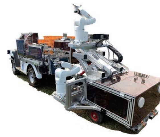
▲ 2アーム式ロボット (収穫適期を認識して自動収穫)
